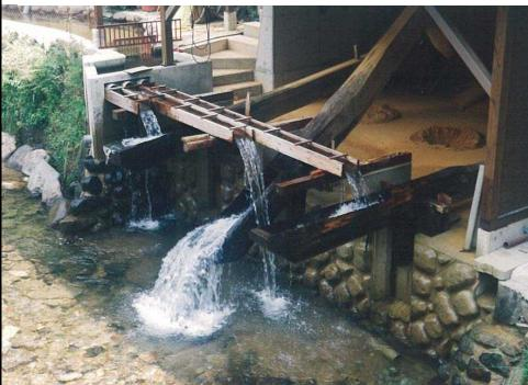
生活に必要な食器を主体とした陶器の製作販売で江戸時代より生活が営まれてきている。焼き物の家を継ぐのは一人のみと決まっており、それが現在も踏襲されている。山からの溪流を樋で引き、写真のような唐臼を自然の力により動かしている。地元の人たちはせせらぎの音に加えて、水の重みで杵を持ち上げるための水が一杯になるときにギーという音、その後唐臼の水が掃ける周期的なザーという音とゴトンという杵が陶土の臼に落ちて土を碎く音が生活に根付いた音としてある。
